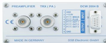
Die Fernspeiseweiche DCW 2004 B dient zur komfortablen Fernspeisung unserer SUPER-AMP Vorverstärker über das Koaxialkabel, sowie für die zeitlich verzögerte Zuschaltung von HF- Leistungsverstärker.
