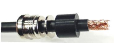
Mit einem Messer 8 mm des Außenmantels entfernen.
