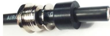
Schieben Sie Mutter, Druckring und Gummidichtung über das Kabelende. Tipp: Mit etwas Vaseline rutscht die Gummidichtung leichter über den Außenmantel.
