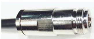
Das so vorbereitete Kabelende bis zum Anschlag in das Steckergehäuse einschieben. Mit zwei Maulschlüsseln 16 mm die Spannmutter handfest anziehen. Ein kleiner Spalt zwischen Mutter und Steckergehäuse sollte noch sichtbar sein!
