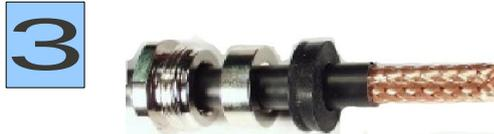
Mit einem Messer 20 mm des Außenmantels entfernen.
