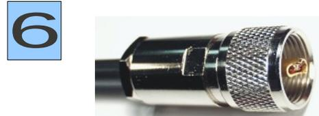
Das so vorbereitete Kabelende bis zum Anschlag in das Steckergehäuse einschieben. Mit zwei Maulschlüsseln 16 mm die Spannmutter handfest anziehen.
