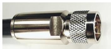
Das so vorbereitete Kabelende bist zum Anschlag in das Steckergehäuse einschieben. Mit zwei Maulschlüsseln 19 mm die Spannmutter handfest anziehen. Ein kleiner Spalt zwischen Mutter und Steckergehäuse sollte noch sichtbar sein!
