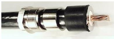
Mit einem Messer die Kupferfolie und das Dielektrikum entfernen. Der Innenleiter muss absolut rund bleiben, die scharfen Kanten entgraten.
