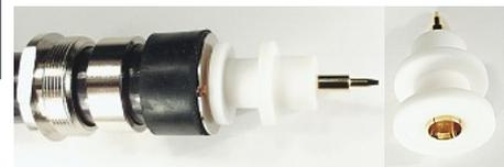
Innenstift in Teflon-Isolator schieben. Anschließend Innenstift vorsichtig auf den Innenleiter aufstecken. Tipp: Der Innenleiter kann vor dem Aufstecken des Innenstiftes mit einem hauchdünnen Vaseline-Film versehen werden. Das verbessert die Intermodulationsdämpfung und beugt Korrosion vor.
