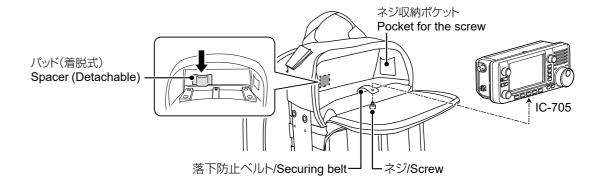
◎ IC-705を本製品に収納した状態で運用する場合、アンテナは、L型の変換コネクター(市販品)を使用して接続してください。
